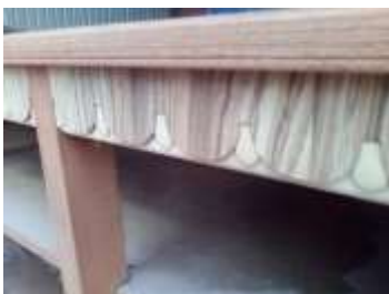
Aérogommage : détail d'un meuble ramené au bois brut
